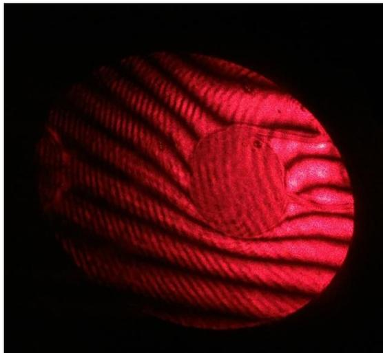
Abbildung 3: Interferenzbild des kalten Heizwiderstands
